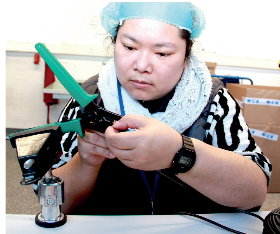
Maria Pang isoliert Kabel für die Weiterverarbeitung ab.
